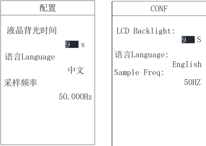
图 4.8 液晶背光时间设置 Figure 4.8 LCD backlight time setting
