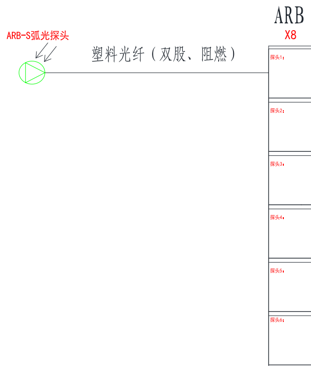
图 3.10 弧光采集接口光纤连接示意图
