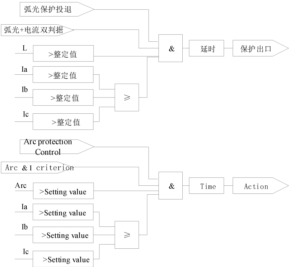
图1.2 弧光和电流双判据保护逻辑示意图
