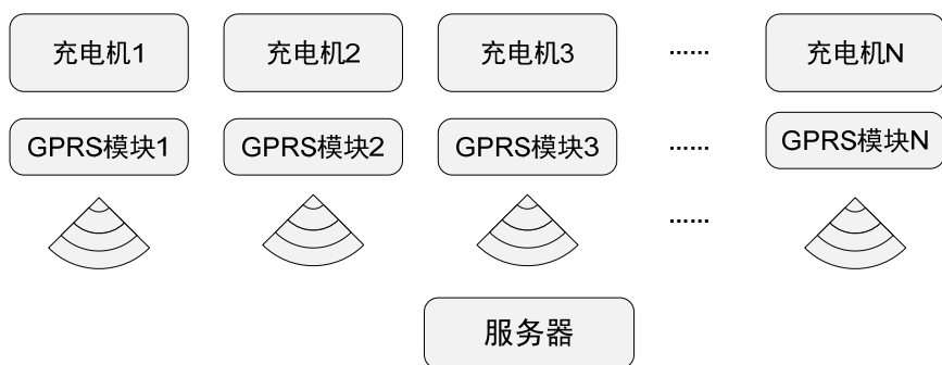
图 2-8 无线组网示意图
