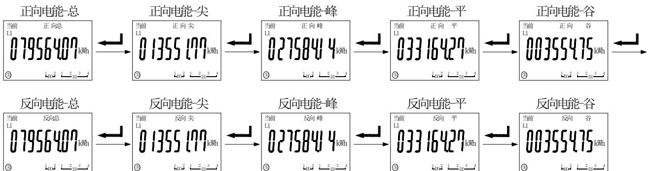
仪表开机后显示电流显示界面时，按右键切换到历史月电能查询显示界面后，按回车键切换显示：所查月正向有功电能（尖）→所查月正向有功电能（峰）→所查月正向有功电能（平）→所查月正向有功电能（谷）→所查月反向有功电能（总）→所查月反向有功电能（尖）→所查月反向有功电能（峰）→所查月反向有功电能（平）→所查月反向有功电能（谷）→查询电能的日期设置（年、月）。
